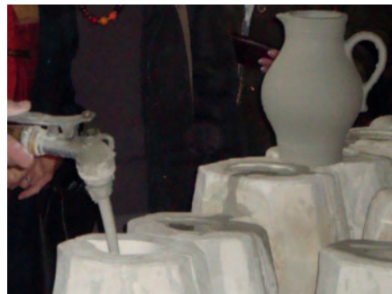
Befüllen einer Gipsform mit Schlicker - Hohl-guss.
