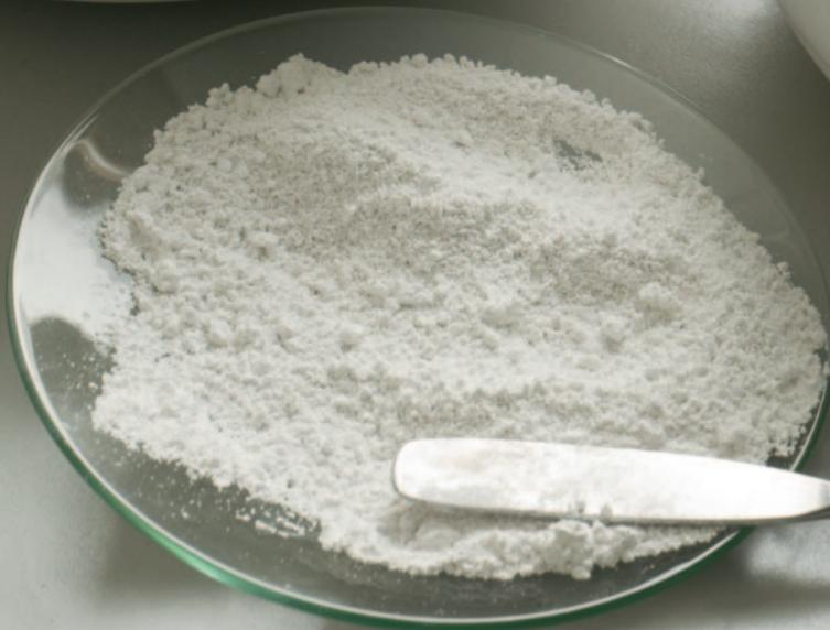
Die Neuburger Kieselerde stellt eine untrennbare Mischung aus Kaolinit und feinsten Kieselsäurepartikeln dar. Sie kommt als hochwertiger Füllstoff in Farben und Lacken oder in Kunststoffen wie Elastomeren und Thermoplasten zum Einsatz. Auch in der Bauchemie, in Kleb- und Dichtstoffen, in Polier- und Reinigungsmitteln, Papierbeschichtungen, im Pflanzenschutz oder in der Kosmetik und Körperpflege findet sie Verwendung.
