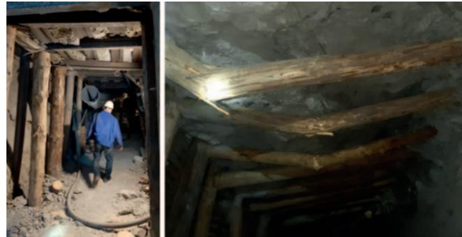
Strebausbau in Holz. Nur »warnfähiges« langfaseriges Weichholz darf verbaut werden.
