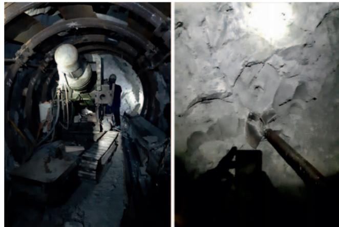
Vor Ort. Gewinnung mit der Vetter'schen Tongewinnungsmaschine. Lösen des Glashafentons mit der Schnecke.
