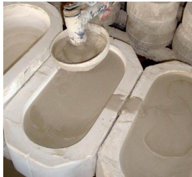
Befüllen einer Gipsform mit Gießschlicker
