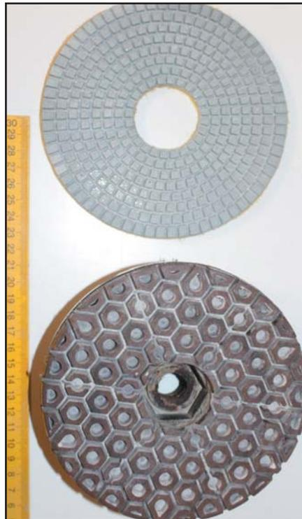
Typische DIA-Schleifkörper mit Kunstharzbindung. Oben für die Montage mit Klett-haftung, unten Kantenschleifring mit Wabenstruktur
